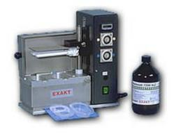
Elle sert à enrober l'échantillon dans du plastique (technovit 7200) en le polymérisant. Ce qui a un effet thermal minimal sur l'échantillon, qui subit une polymérisation stable avec un fort degré de durcissement
