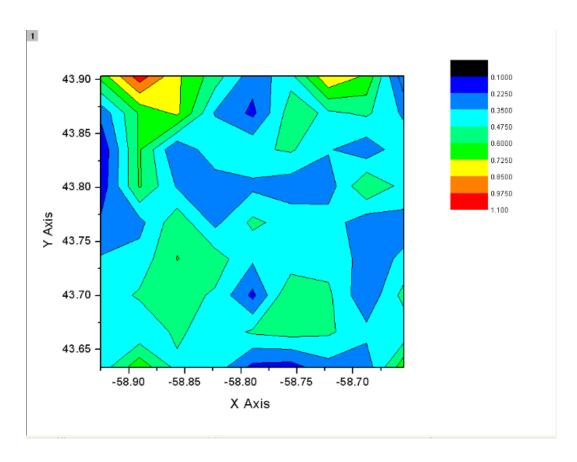
Et finalement, on a le graphe H/E (en Z) en fonction de la position de l'indentation en X et en Y.
