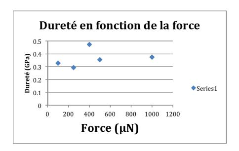
Comme vous pouvez le constater, le module et la dureté restent respectivement aux alentours de 19 GPa et 0.36 GPa. Et en appliquant une force de 500  $\mu$ N, on peut voir qu'on a un module de 18.7 GPa et une dureté de 0.355 GPa. Donc, la force de 500  $\mu$ N est retenue pour le test final.
