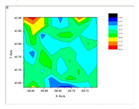
Le deuxième graphe représente la dureté (en Z) en fonction de la position de l'indentation en X et en Y. À l'instar du graphe du module, on remarque que la valeur de H dans la plupart des zones est d'environ 0.35 GPa. Ce qui se rapproche des valeurs trouvées pour le test préliminaire.
