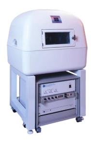
Cet appareil est idéal pour mesurer la dureté et le module d'élasticité des échantillons. Il offre la capacité de réaliser des tests nano-mécanique quantitative dans un confort d'automatisation.
