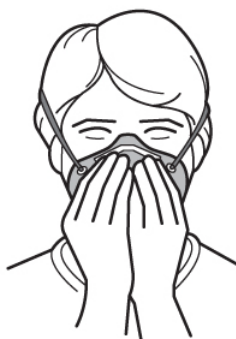
Figure 5 : Vérification de l'étanchéité des appareils de protection respiratoire jetables
