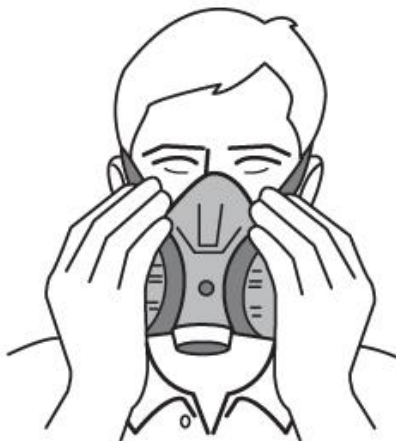
Vérification de l'étanchéité à la pression à vide
